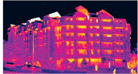
Стамбена ламела материјализована у фасадној опеци. Термограм приказује приметне губитке топлоте у зонама хоризонталних, наглашених, армирано бетонских серклажа односно на местима проласка тераса кроз термички омотач. Фасадна столарија је у лошем стању са изразитим топлотним губицима нарочито у зони кутија за ролетну. Приметни су изразити добици топлоте од соларног зрачења на лифт кућицама.
