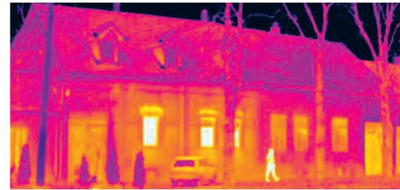
Породична кућа са изразито масивним, хомогеним, фасадним зидовима од ћерпича без термоизолације. Термограм приказује топлотне губитке кроз целокупну површину зидова са повећаним интензитетом у зони изнад прозорских отвора. Десна половина објекта се не греје. Конструкција прозора је неодговарајућа са изразитим топлотним губицима. Улазне капије и капци прозора се читавају као топлији услед сунчевог зрачења.
