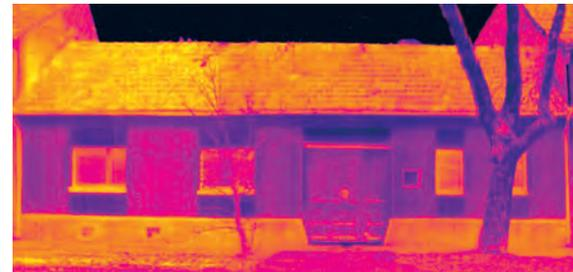
Породична кућа са изразито масивним, хомогеним, фасадним зидовима од опеке без термоизолације. Термограм приказује секундарно загревање од сунчевог зрачења са највећим интензитетом у зони крова као и фасадним испунама између прозора. Делови зида изнад и испод прозора су бојени светлом рефлексивном бојом што за резултат има мање топлотне добитке. Приметни су губици топлоте у зони прозорских отвора.
